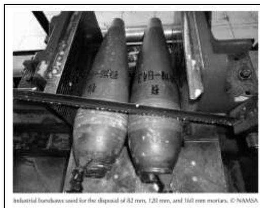
Esse método utiliza diversos tipos de maquinário como serra, fresa, torno, dispositivos de corte hidroabrasivo, para seccionar a munição em partes, possibilitando sua posterior destruição (OSCE, 2008, p. 154).
