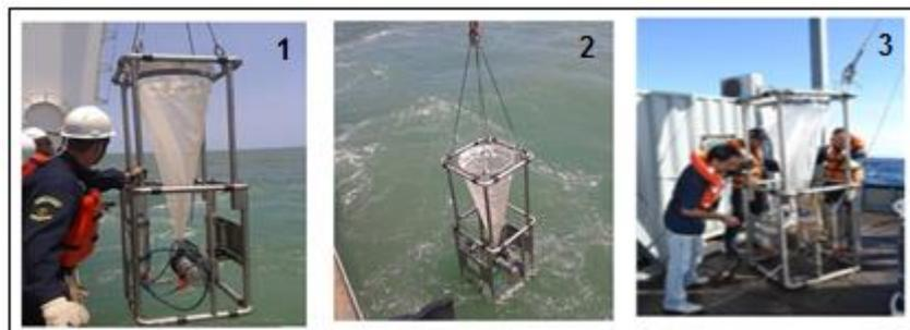
Figura 2 Utilização do equipamento LOKI em três momentos distintos, na imagem 1, sendo levado para fora do navio para então ser lançado verticalmente, como mostra a imagem 2, e no último estágio, imagem 3, o LOKI já no deck do navio, pronto para ter os dados descarregados em um computador.
