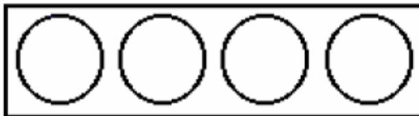
Figura 1.2 Cilindros dispostos em linha
