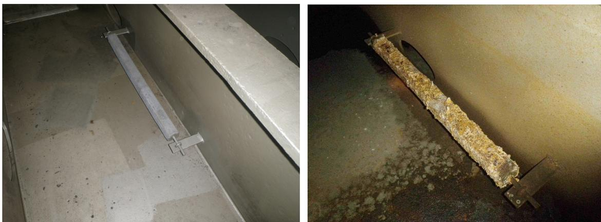
Figura 3.10 Condição de anodos no fundo do tanque antes e após viagem em lastro (acervo pessoal)
