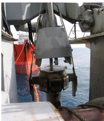
Figura 4.4 – Coupler valve pronta para conectar no BLS do navio.
