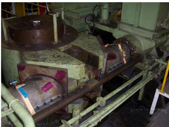
Figura 5.1 – Travamento da máquina do leme após navegação (Acervo Pessoal).
