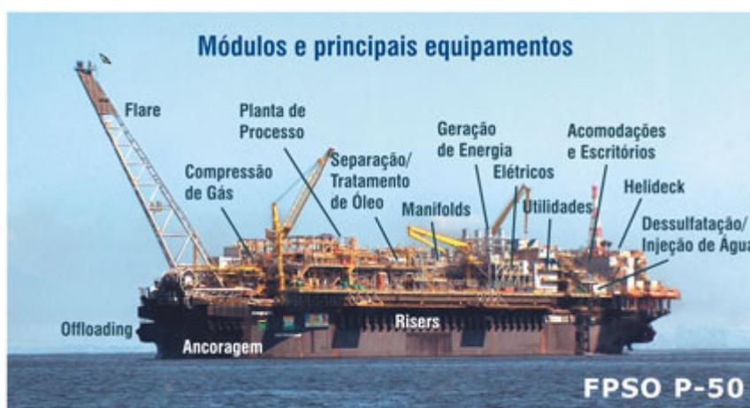
Figura 1.2 - Principais equipamentos de um FPSO.
