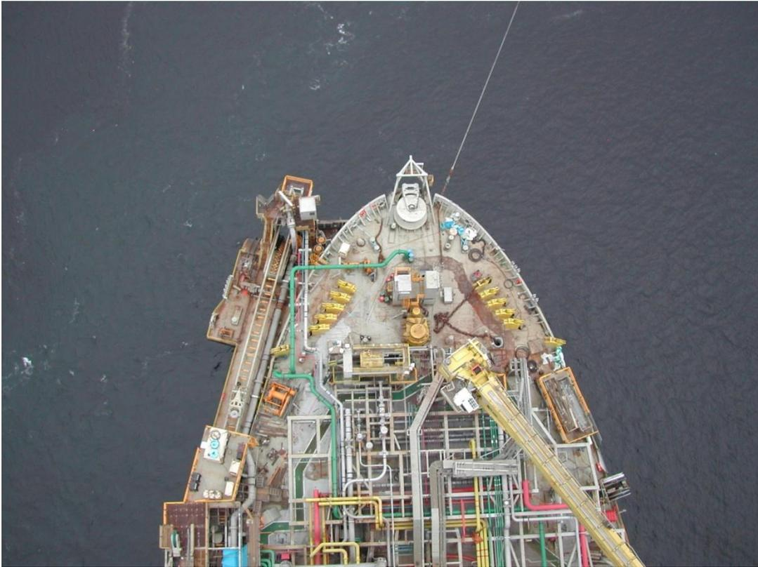
Figura 25 – visão de cima da proa de um aliviador com Sistema de ancoragem DICAS
