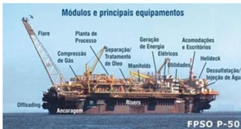
Figura 03 - Fonte: [www.mauajurong.com.br/pag/img\\_comp/t\\_FPSOP50\\_gd.jpg](http://www.mauajurong.com.br/pag/img_comp/t_FPSOP50_gd.jpg)
