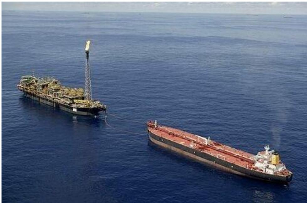
Figura 20 – Operação de offloading. Fonte: Petrobras – UN-RIO – Projeto Barracuda/Caratinga
