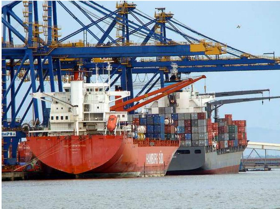
Figura 46 – O navio de cor vermelha está operando com os dois novos porteineres.
