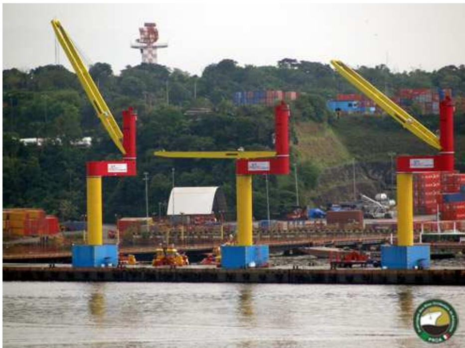
Figura 8 – Guindastes para operação de contêineres e carga geral.
