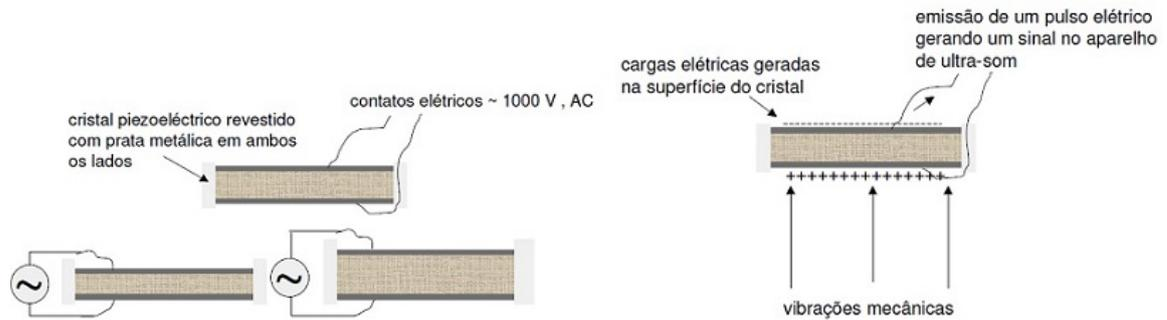
**Figura 16 - Contração e expansão do cristal submetido a alta tensão alternada**
