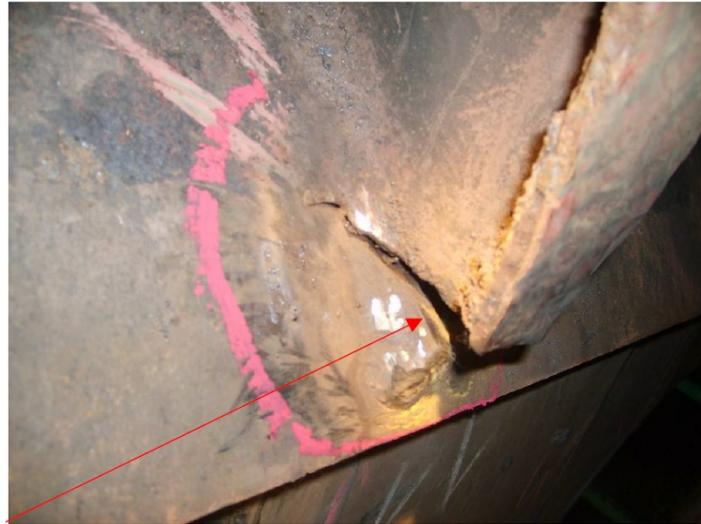
**Figura 8 - Exemplo de fratura**
