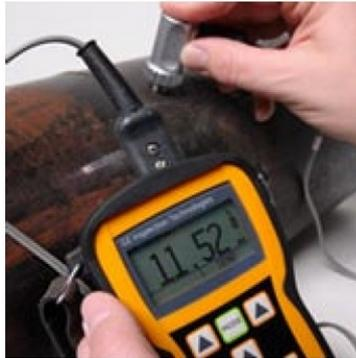
**Figura 24 - Medidor de espessura digital ultrassônico**
