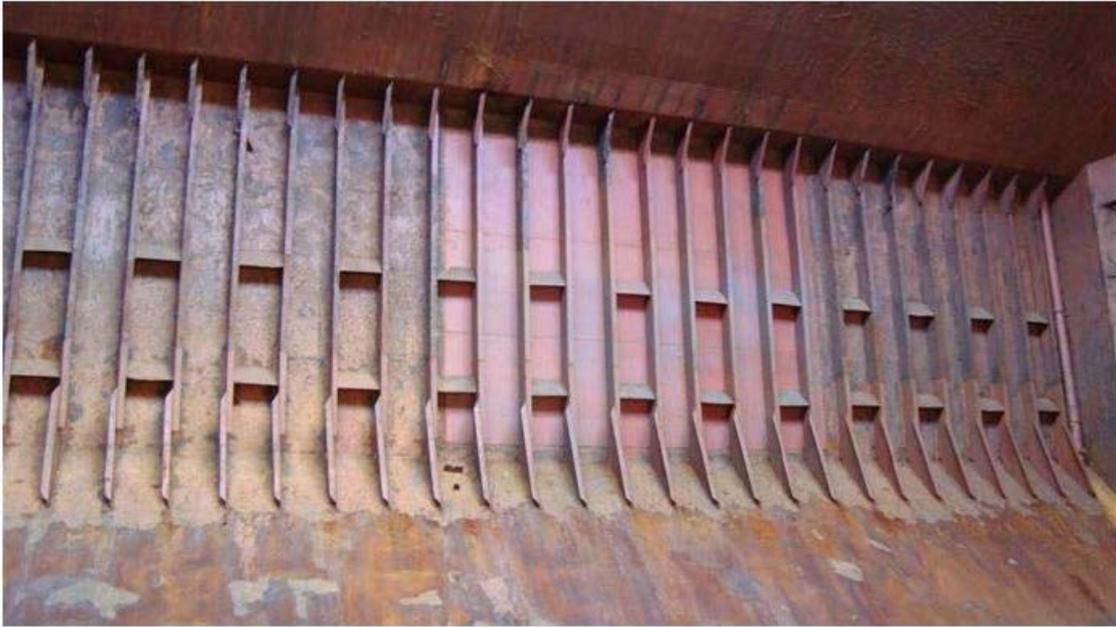
**Figura 44 – Porão com tripping brackets entre cavernas.
