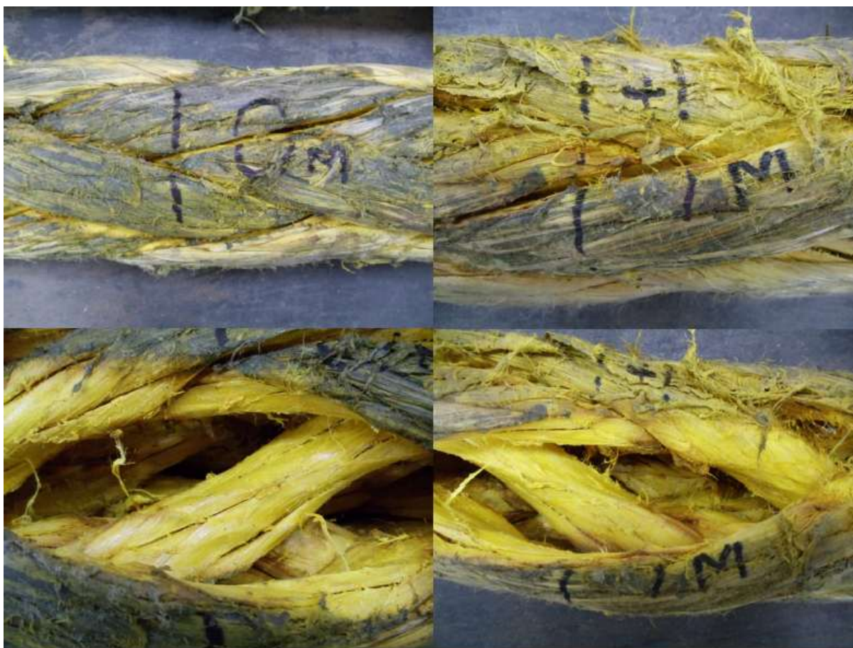
Figura 7: Danos encontrados nos cabos de fibra
