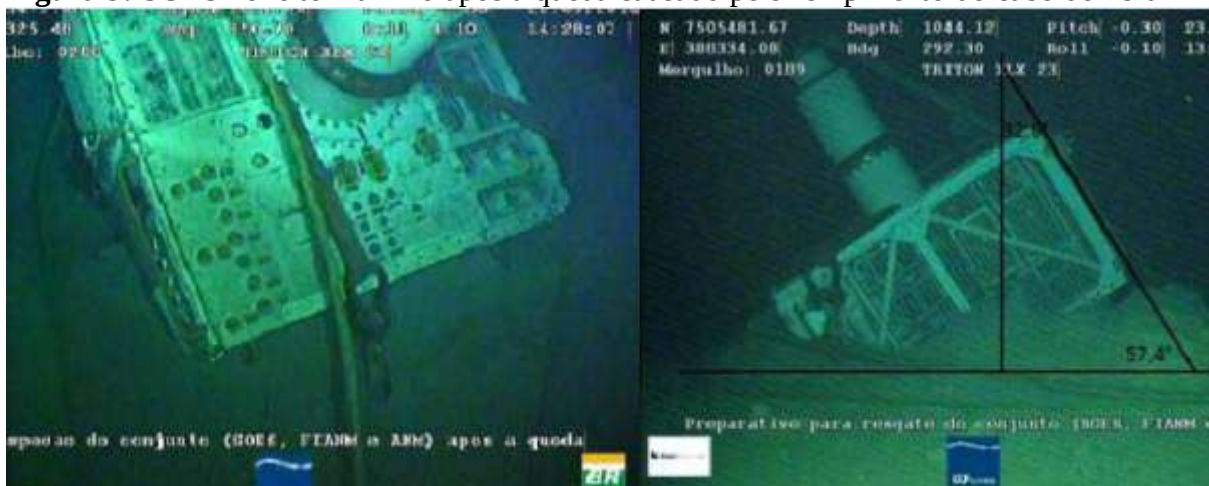
Figura 9: SOES no leito marinho após a queda causado pelo rompimento do cabo de fibra
