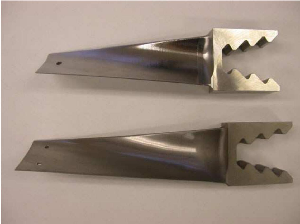
**Figura 8 - Fixação “Árvore de Natal” (Fir Tree Root)**
