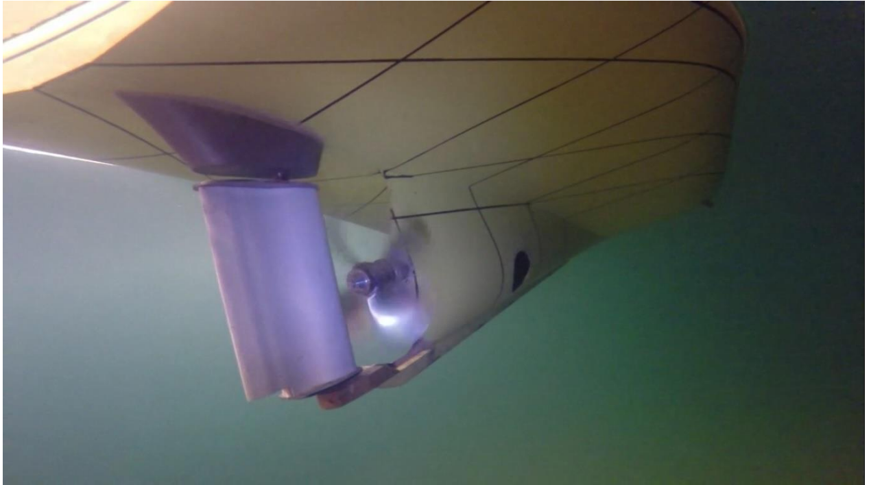
Figura 36: Mecanismos de propulsão e de governo instalados em modelo
