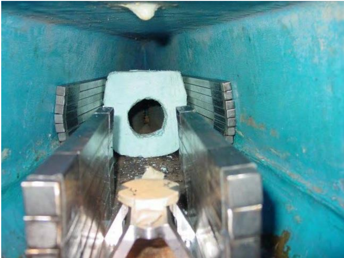
Figura 33: Barras de metal sendo utilizadas como lastro em modelo
