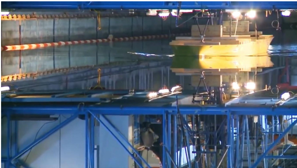
Figura 35: Teste em modo captive do casco do Triple E
