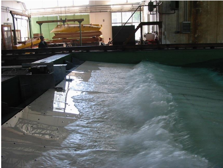
Figura 28: Praia artificial regulável construída em um tanque de provas
