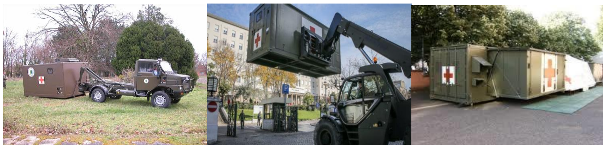
Figura 17 – Hospital de campanha formado a partir de containers .
