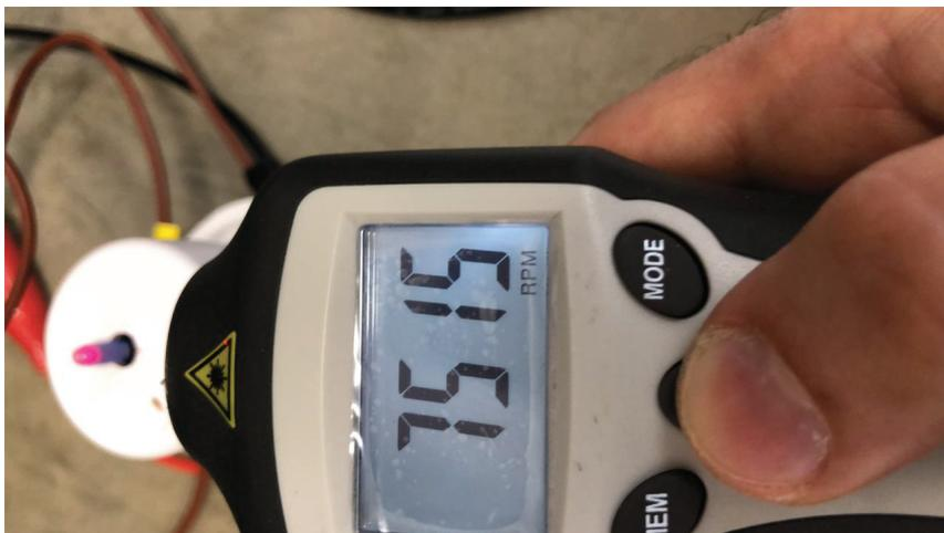
Figura 2.7: Tacômetro medindo RPM do motor.
