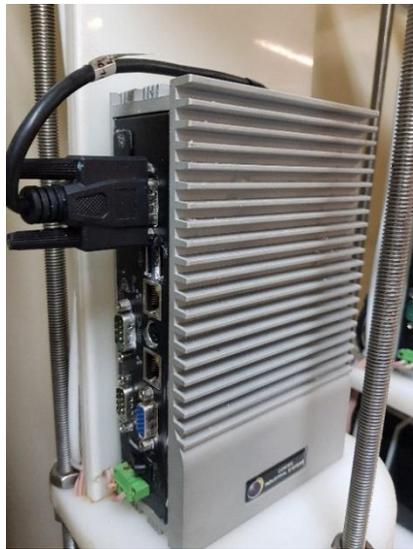
**Figura 30: Unidade de processamento ASRock, AD525PV3.**
