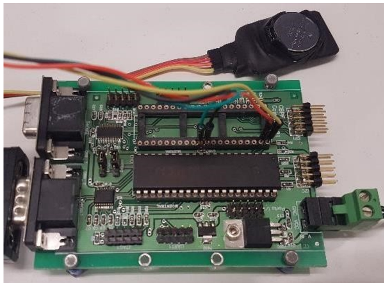
Figura 22 - Adaptação do módulo RTC DS3231 na placa eletrônica do sistema embarcado.
