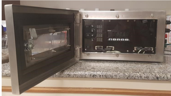
Figura 37 - Caixa de aço inox onde foi acondicionada toda a eletrônica do sistema.
