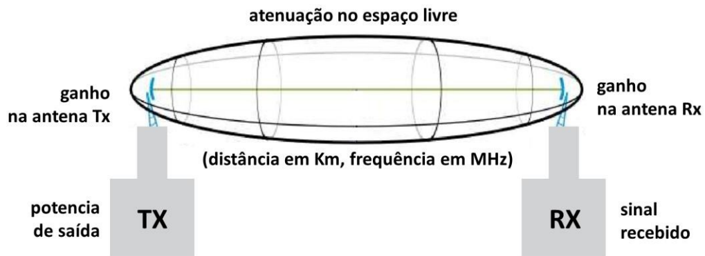
Figura 31 - Representação esquemática dos termos utilizados no cálculo de viabilidade do enlace rádio.
