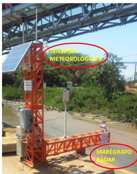
Figura 3 - Estação meteomaregráfica do projeto SiMCosta. Adaptado de (IBGE, 2016).
