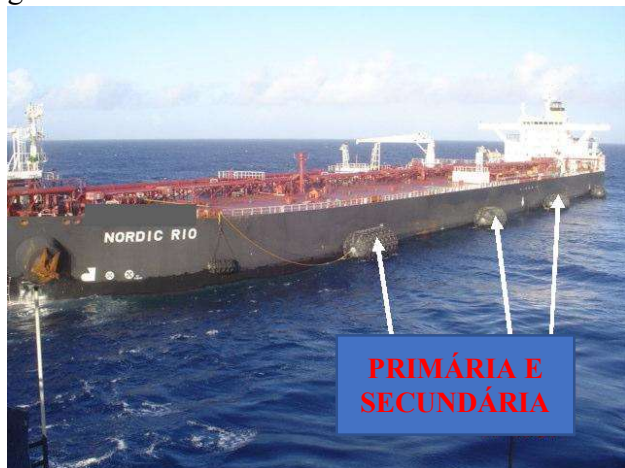
FIGURA 10.0 Defensas (primárias e secundárias) posicionadas na manobra a contrabordo no corpo paralelo
