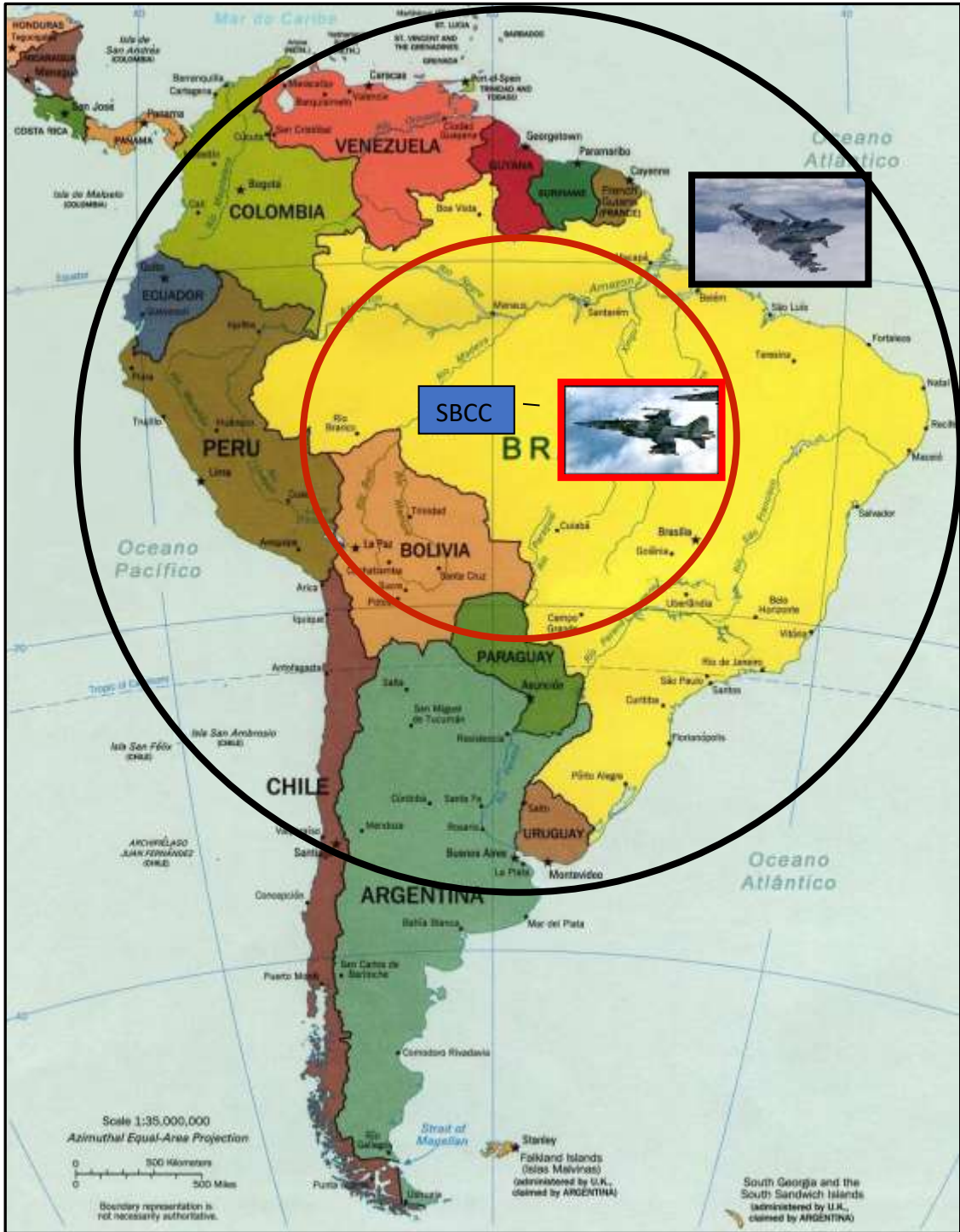
FIGURA 2: demonstraç o do raio de alcance do GRIPEN NG (linha preta) e do F-5M (linha vermelha) em configura o de m ximo alcance com decolagem e pouso de SBCC (Aer dromo de Cachimbo).
