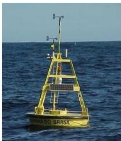
Figura 3.4 - Boia Minuano, dotada de ondógrafo não direcional.
