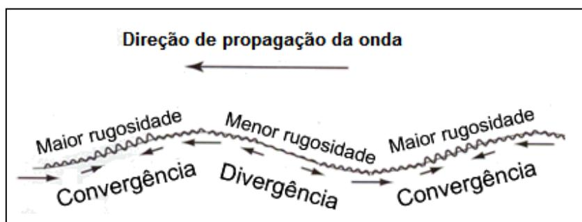
Figura 2.13 - Modulação hidrodinâmica da rugosidade pelas correntes de superfície associadas ao movimento orbital.
