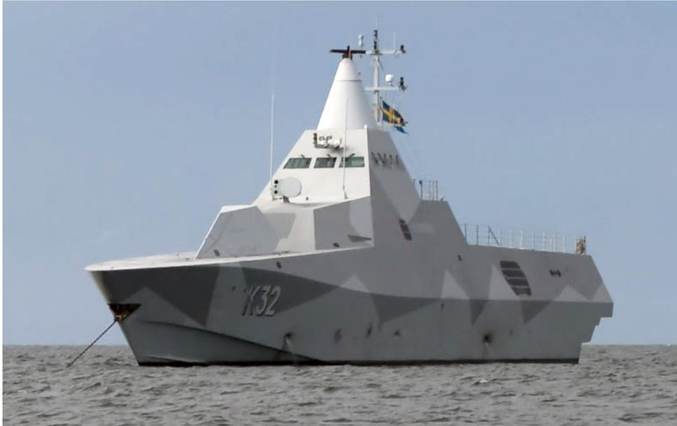
FIG. 1.7: Emprego militar de material absorvedor eletromagnético na estrutura da corveta classe *Visby* da Marinha Real da Suécia.
