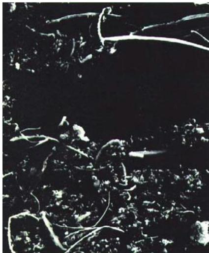
Figura 2.14 - Desgaste por abrasão a dois corpos. (LUBRIN).
