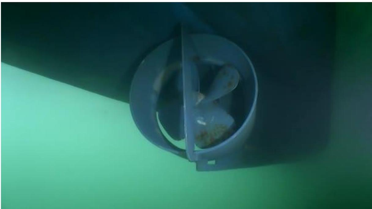
Figura 3: Propulsor submerso.
