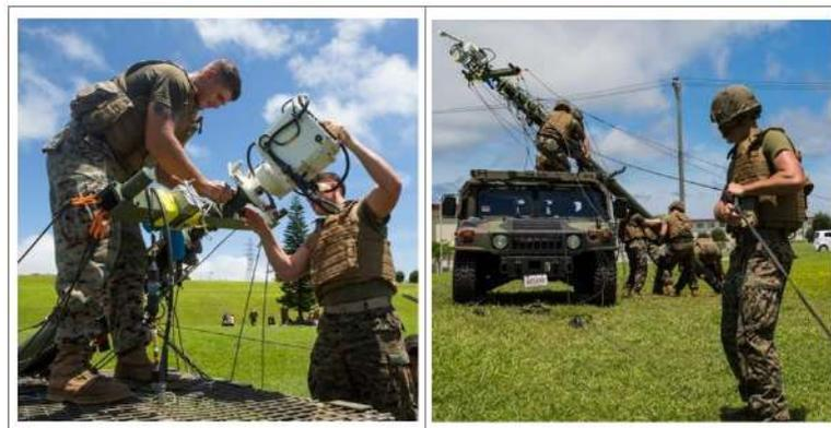
**Figura 1.6** – Instalação de terminal FSO em base terrestre em Okinawa (SPUTNIK, 2018).
