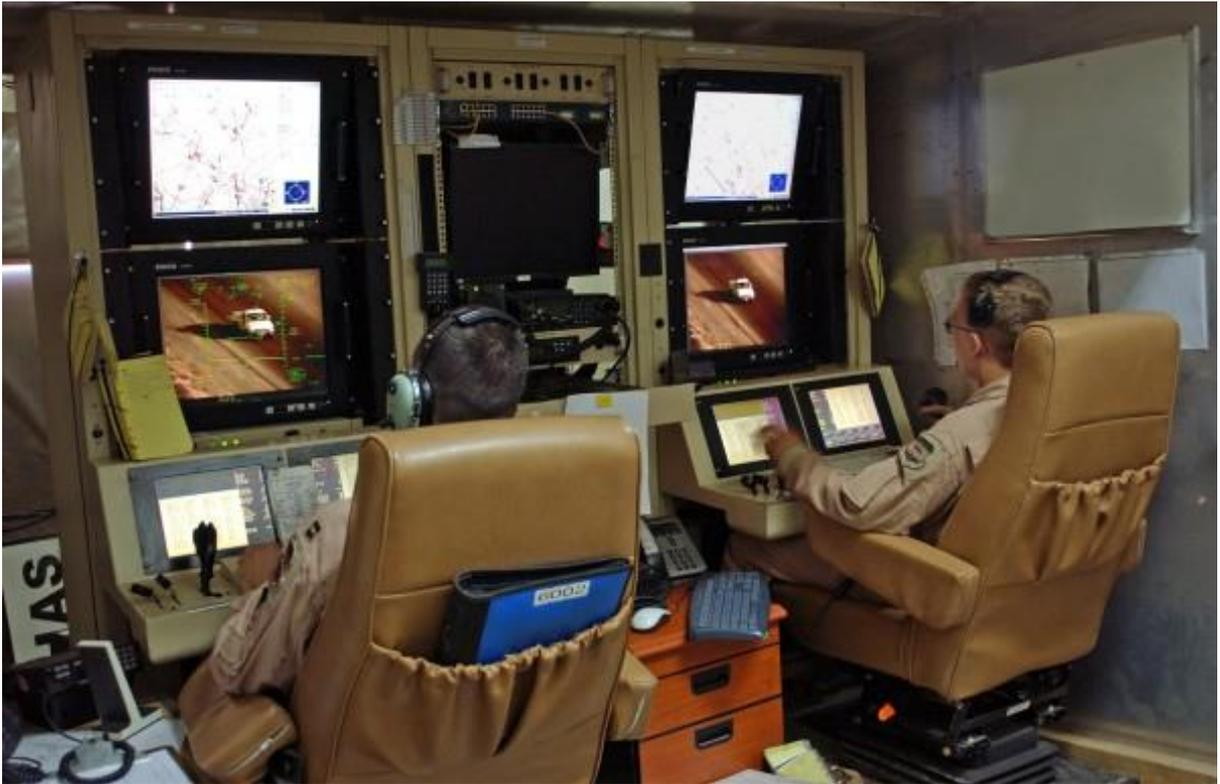
FIGURA 1- Interior de uma estação terrestre de controle de operação das ARP
