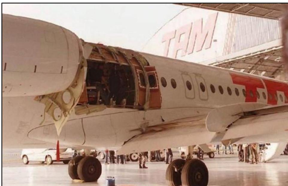
Figura 3: estado final da fuselagem do Fokker 100 após a explosão ocorrida em pleno voo.
