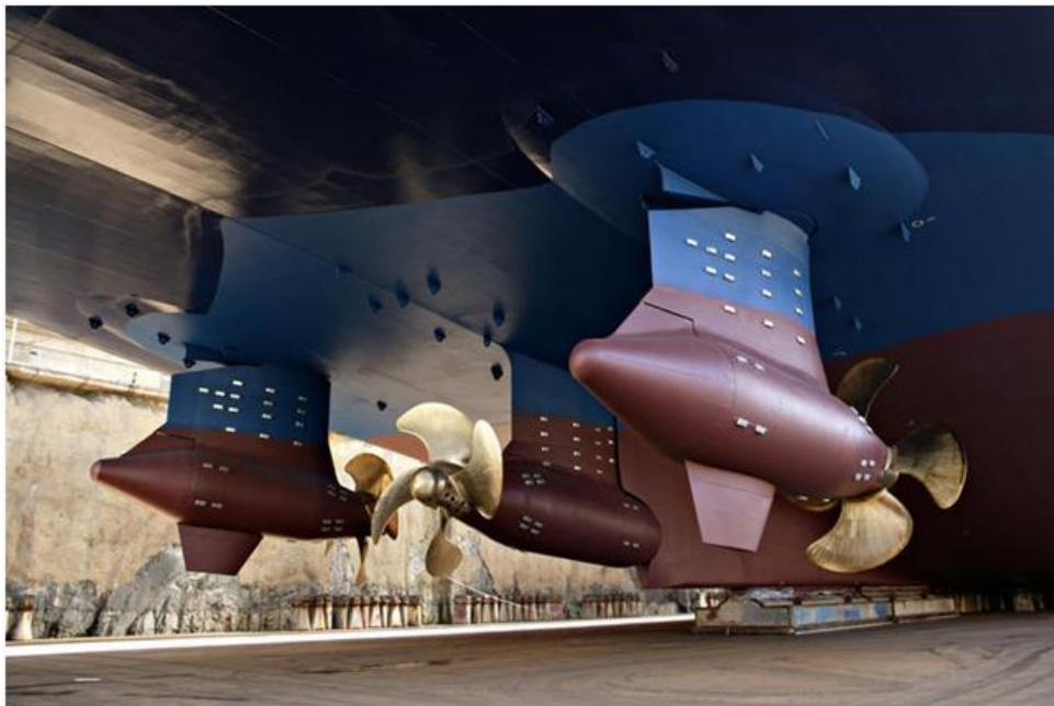
Figura 26: Propulsão AZIPOD no navio Freedom of the seas
