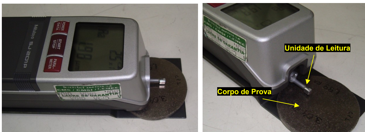
Figura 5.8 - Rugosímetro digital SJ-201P – Mitutoyo.
