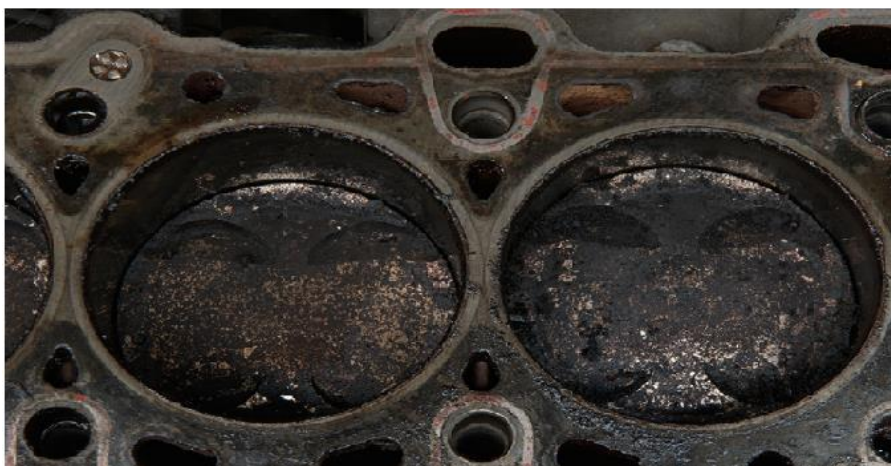
Figura 3: Resíduos de carbonização.
