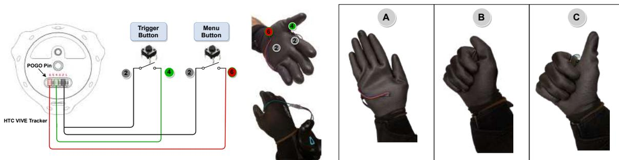
Figura 4.5 – Luva adaptada e sua conexão *POGO Pin* ao VIVE™ Tracker simulando os botões dos controles VIVE™. A imagem *A* representa a postura de mão aberta; a imagem *B* representa a mão fechada; e a imagem *C* representa a mão fechada com o polegar estendido.
