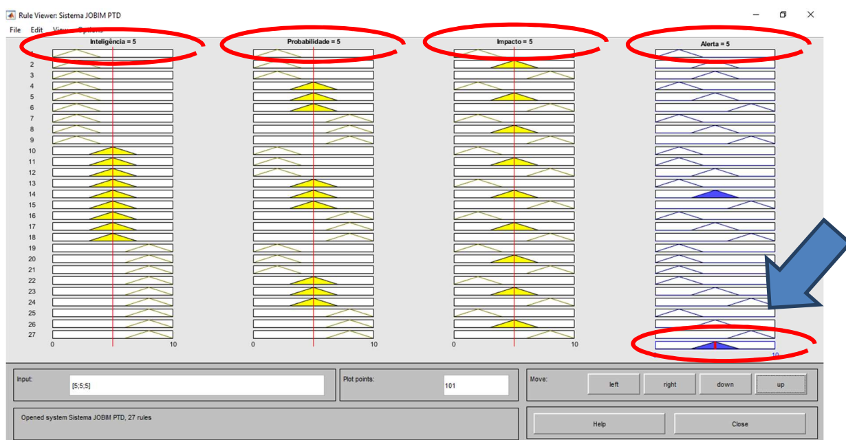
Figura 15 – Visualização do sistema de manipulação das regras com efeito na saída (nível de alerta)
