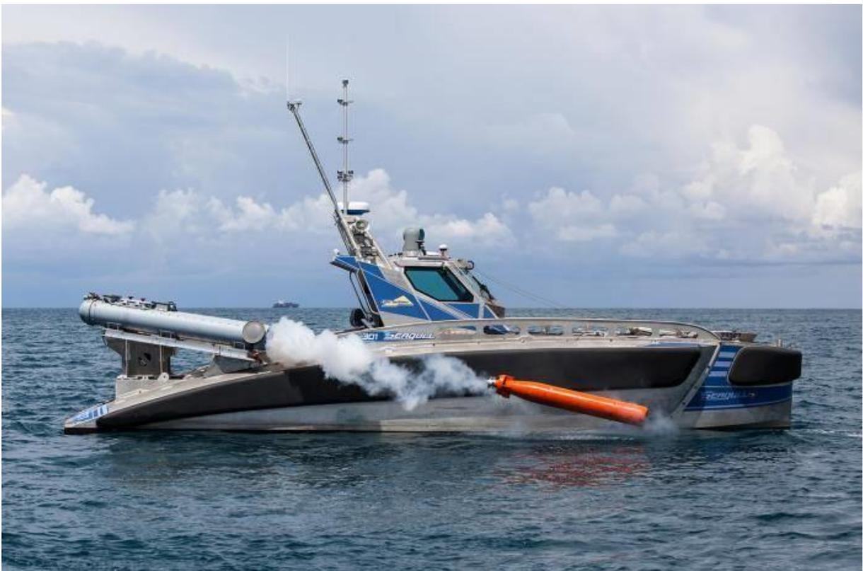
Fig. 10 – Seagull USV lançando torpedo em simulação de guerra AS.
