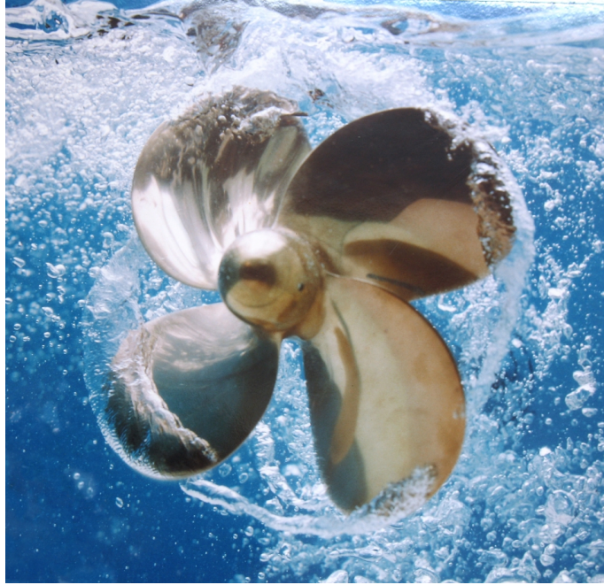
Figura 2.2: Bolhas sendo formadas pelo processo de cavitação na hélice de um navio.
