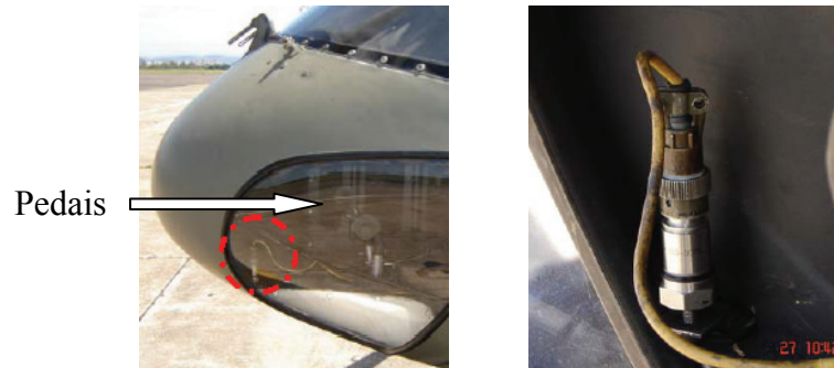
Figura 8 – Posicionamento do acelerômetro na cabine [14]
