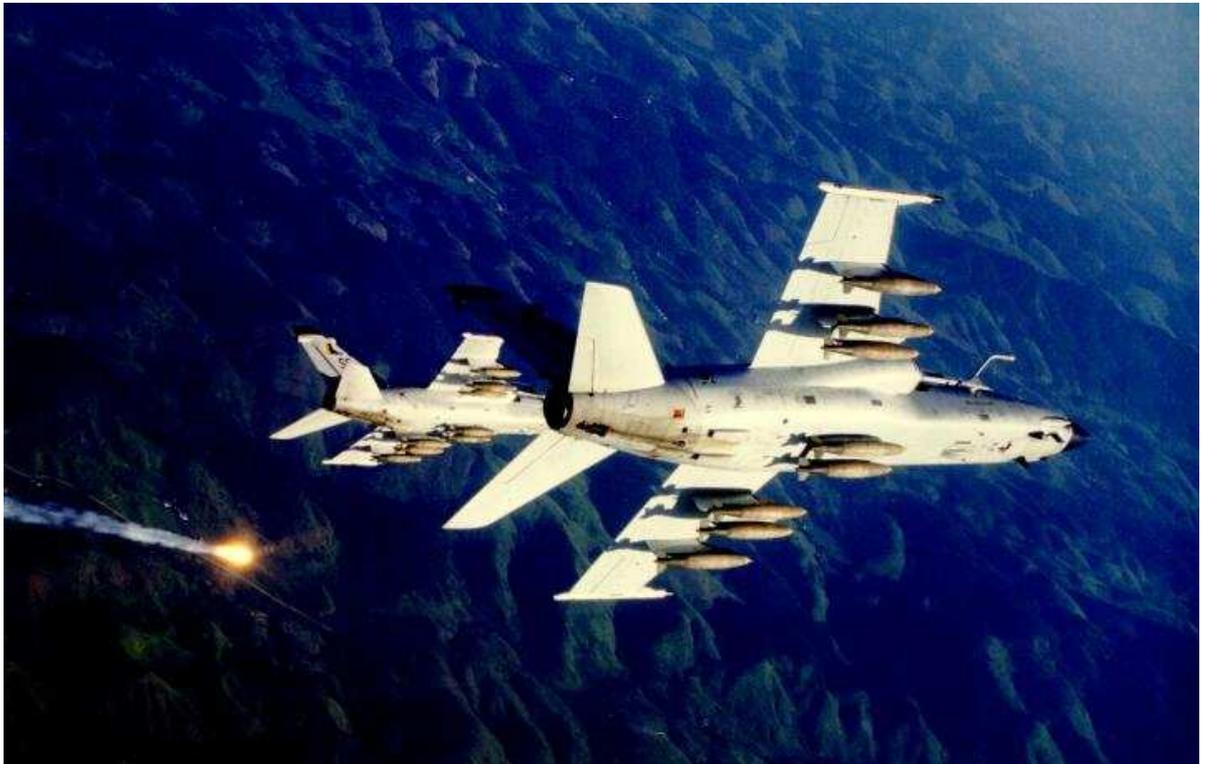
Figura 25- Sistema Integrado de Auto Defesa
