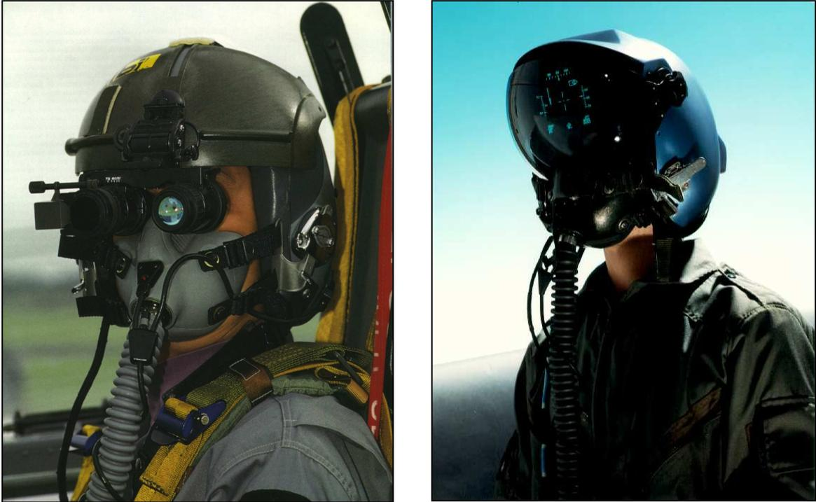
**Figura 5 - Sistema Visão Noturna e HMD**
