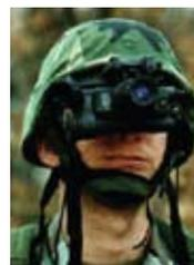
Figura 2a – Óculos AN-PVS-7D adaptado para capacete
