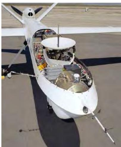
Figura 3 - Eletrônica embarcada em um SARP (ENGENHARIA AERONÁUTICA, 2021)
