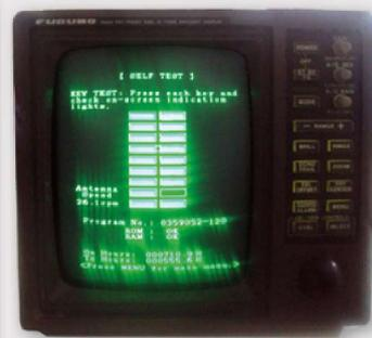
**Módulo Transceptor de controle e Display do radar** | Fotos do autor
