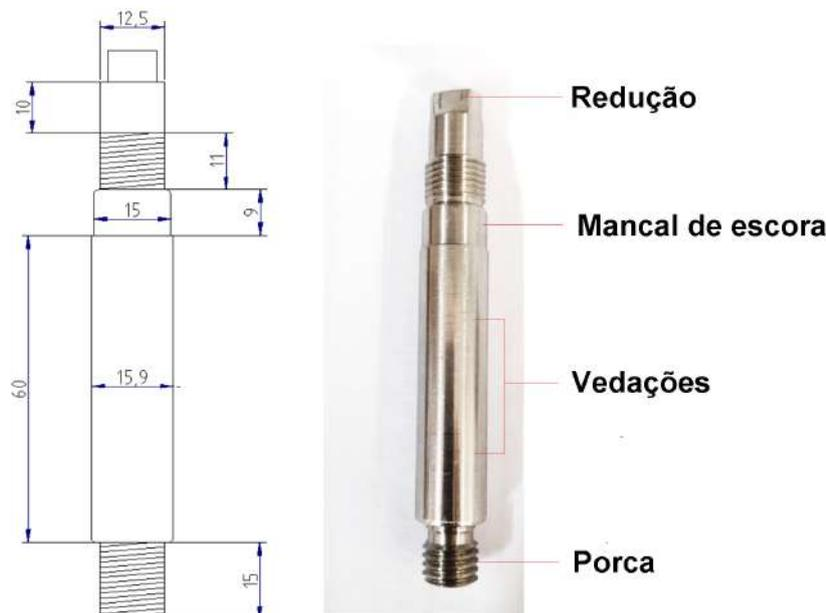
Figura 3.7: Desenho de fabricação especificando as principais medidas do eixo, à esquerda. Eixo fabricado em aço inox indicando as posições dos componentes periféricos, à direita.
