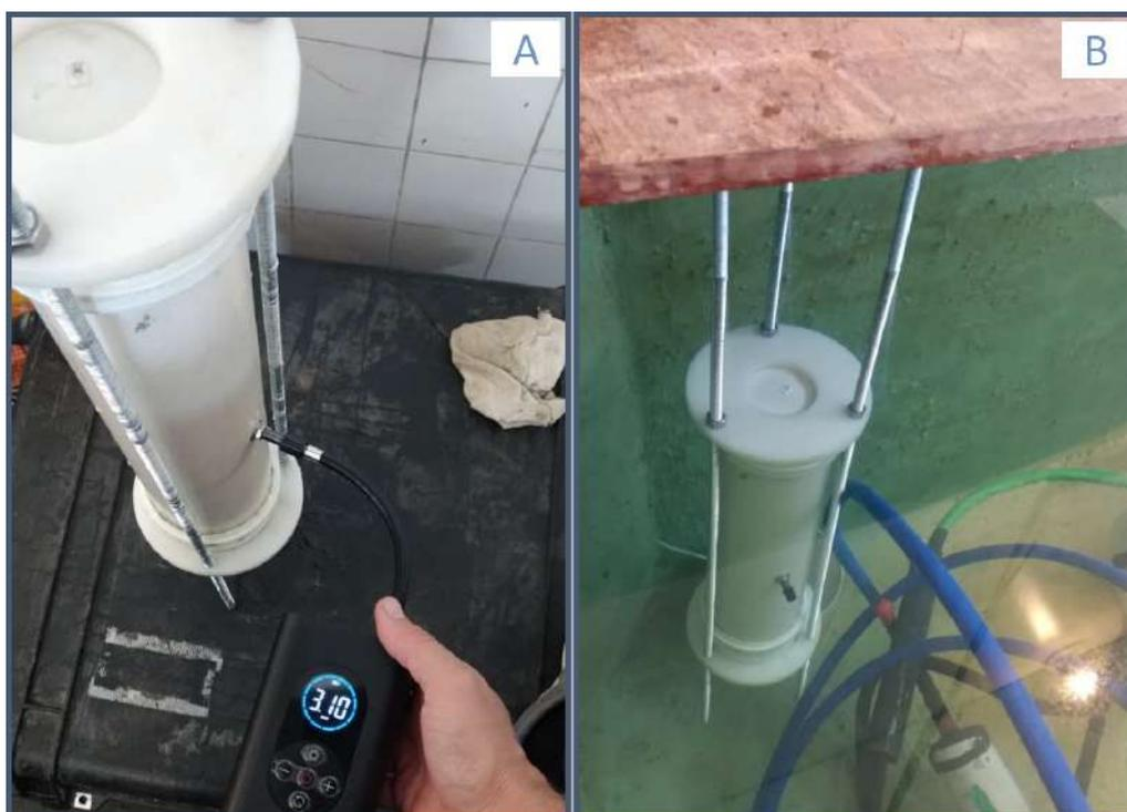
Figura 4.2: Pressurização do invólucro e posicionamento no tanque de prova para teste de estanqueidade.
