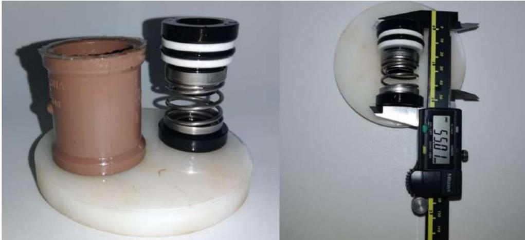
Figura 3.2: Componentes da selagem do eixo principal.
