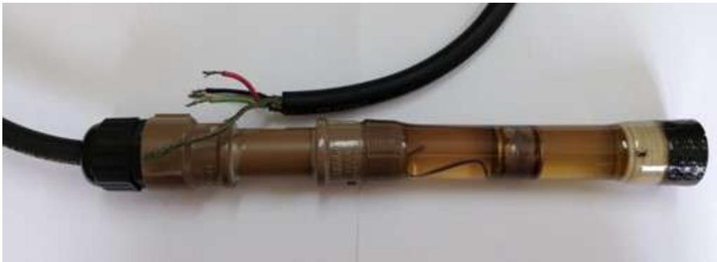
Figura 2.16: Hidrofone desenvolvido no IEAPM com material de baixo custo.
