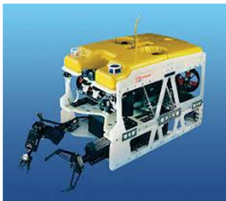
FIGURA 2 - Veículo de Operação Remota de Intervenção ou Intervention Remotely Operated Vehicle (iROV). Fonte: disponível em: < http://www.underwaterengineering.net >
