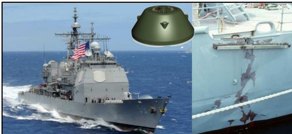
**Figura 9** – Danos causados por explosão sem contato no cruzador USS Princeton.
