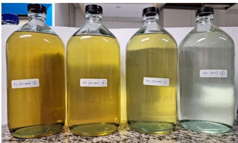
Figura 21 – Amostras P2  $t_1$ , P3  $t_1$ , P4  $t_1$  e P5  $t_1$ , da esquerda para a direita, com visível gradiente de cor entre a mistura com maior teor de ODM (P2) e o QAV-5 puro (P5).
