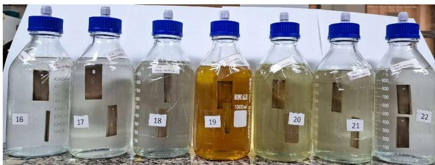
**Figura 11 – Amostras dos frascos 16 (F16) ao 22 (F22) utilizadas para o preparo do QAV-5  $t_3$ .**
