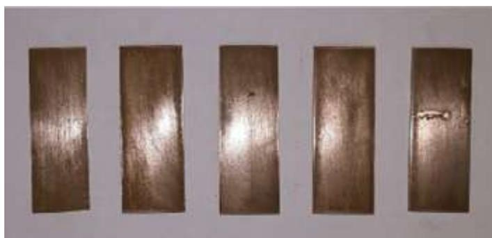
B – Corpos de prova de CuNi após o tratamento de superfície.
