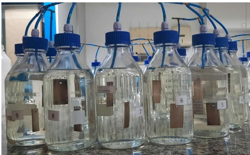
Figura 6 – Arranjo dos frascos de QAV-5 com corpos de prova de CuNi e mecanismo antiexplosivo para escapamento de gás.
