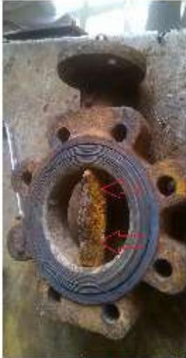
Figura 07 – Válvula intermediária com borboleta corroída.
