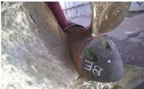
Figura 01 – Bosso do Hélice de BE montado após reparo
