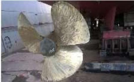
Figura 03 – Hélice de BB montado após reparo
