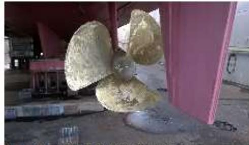
Figura 02 – Hélice de BE montado após reparo
