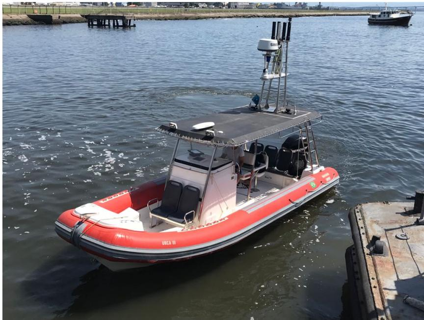
Figura 3: VSNT-LAB (Veículo de Superfície Não Tripulado Laboratorial)
