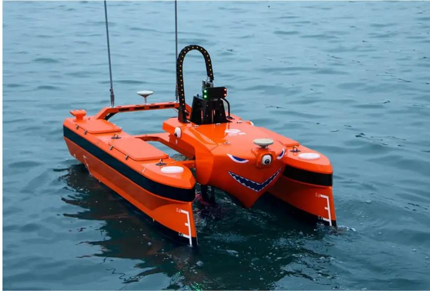
Figura 14: Embarcação de pesquisa hidrográfica autônoma M40 (11)
