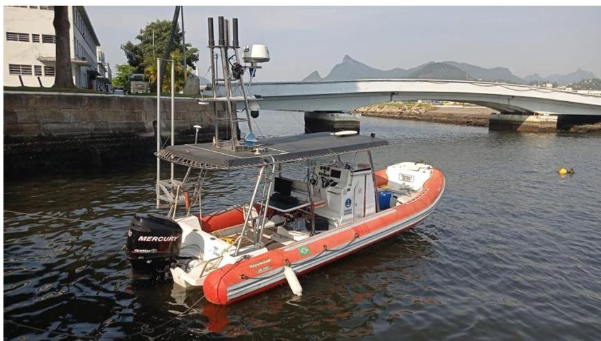
Figura 13: VSNT-LAB utilizando sonar de varredura lateral
