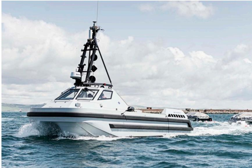
Figura 12: Navio autônomo varredor de minas da Marinha Real Britânica (10)
