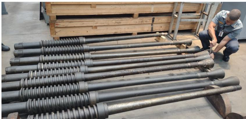
Figura 18 – Tubos do canhão Bofors 40mm/L70 em medição no CMS.
