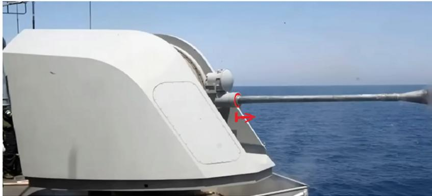
Figura 16 – Ilustração da parte do tubo considerada flexível para a simulação (9).
