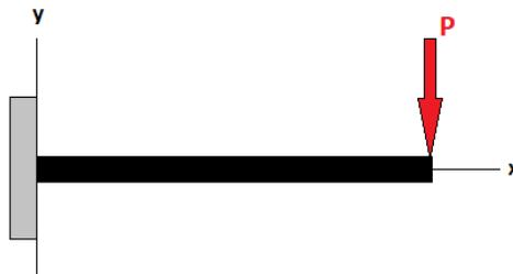
Figura 4 – Viga em balanço com carregamento pontual na extremidade livre.
