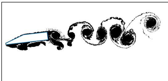
Figura 257 – Esteira.  $Re = 3.0 \times 10^6$ ,  $\alpha = -7^\circ$  e  $t = 3.0$ .
