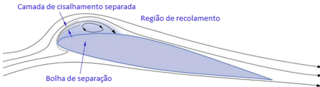
Figura 6 – Formação de bolha de separação no aerofólio. Fonte: adaptado de Gudmundsson(1).
