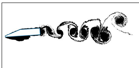
Figura 269 – Esteira.  $Re = 3.0 \times 10^6$ ,  $\alpha = -4^\circ$  e  $t = 3.0$ .
