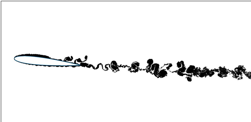
Figura 62 – Nuvem de vórtices de simulação de escoamento ao redor do NACA 0012 discretizado em 250 painéis com  $L = 28$ ,  $Re = 10^6$  e  $\alpha = 6^\circ$ .
