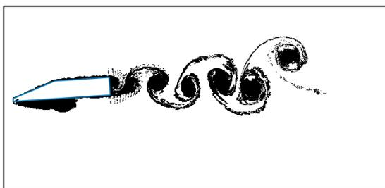
Figura 329 – Esteira.  $Re = 6.0 \times 10^6$ ,  $\alpha = -4^\circ$  e  $t = 3.0$ .
