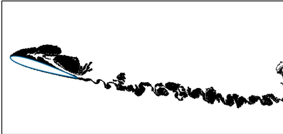
Figura 147 – Esteira.  $Re = 1.7 \times 10^5$ ,  $\alpha = 18^\circ$  e  $t = 3.3$ .
