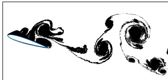
Figura 84 – Esteira.  $Re = 1.7 \times 10^5$ ,  $\alpha = 18^\circ$ .
