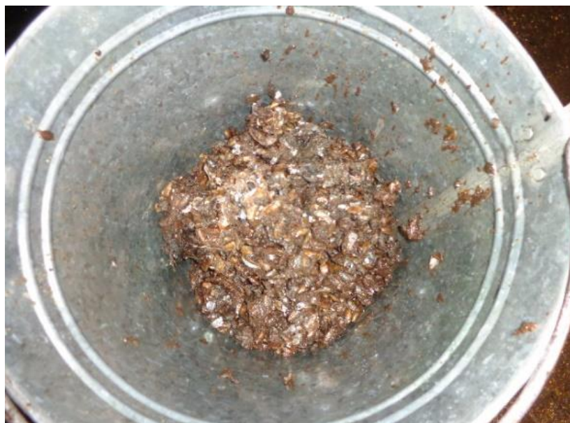
FIGURA 44 – MEXILHÃO RETIRADO DO FILTRO DO SISTEMA DE RESFRIAMENTO DA USINA.
