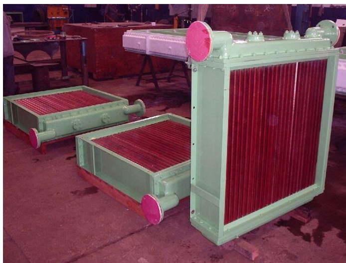
FIGURA 12 - RADIADORES UTILIZADOS NO SISTEMA DE RESFRIAMENTO DO GERADOR.
