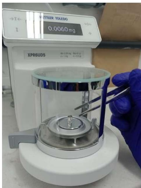
Figura 15: Cápsula de estanho na balança de precisão
