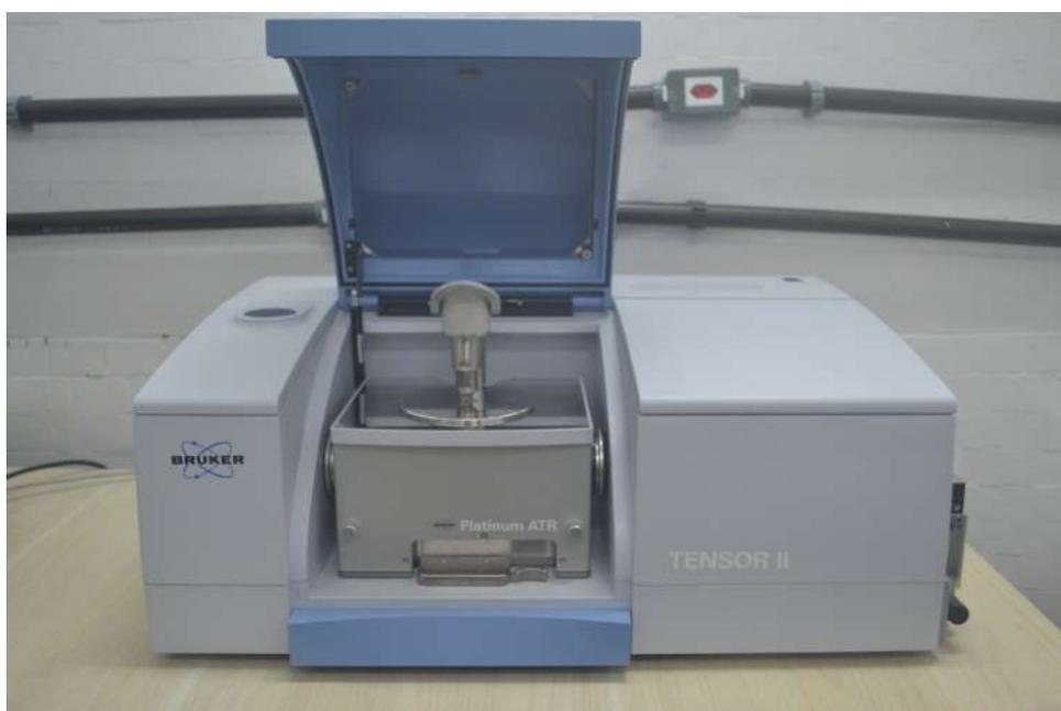
Figura 14: MIRS-FTIR mdodelo Tensor II da Bruker com o acessório ATR - Foto por Pedro Henrique Andrade
