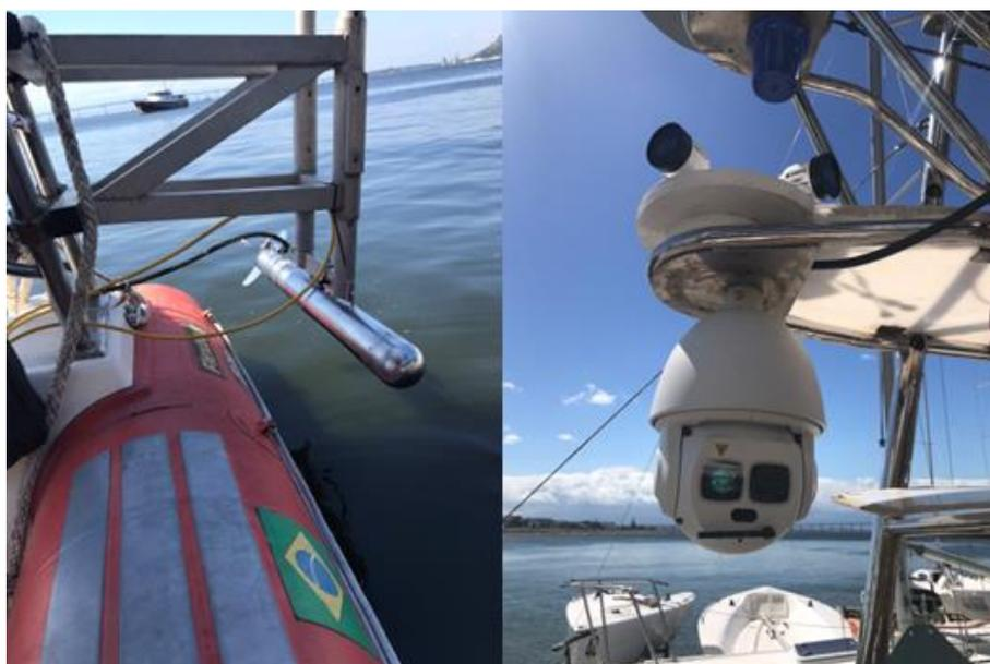
Figura 13 – Sonar *side scan* (esquerda) e câmeras (direita) do VSNT.
