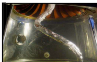
FIGURA 3.5 – Cavitação em vórtice em uma turbina Francis (SILVA, 2018)
