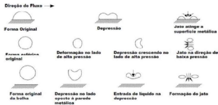
FIGURA 3.4 – Colapso da bolha em três situações características, (SILVA, 2018)
