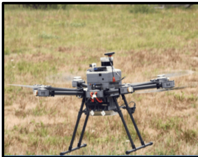
Figura 9 - Drone com capacidade de detecção NBQR da empresa Draper Fonte: dronelife.com(2024)
