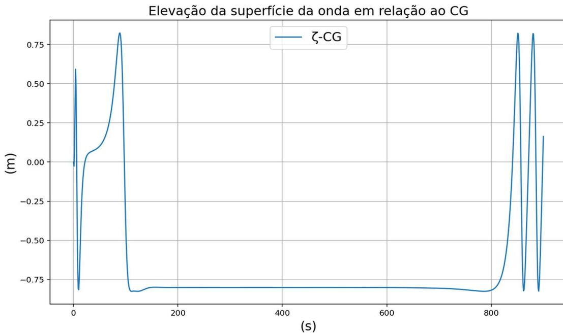
Figura 32 – Elevação da onda em relação a superfície média, medida na posição longitudinal do CG do navio e expressa em  $FRA$  ( $H=1,65m$ ;  $T=5,94s$ ).
