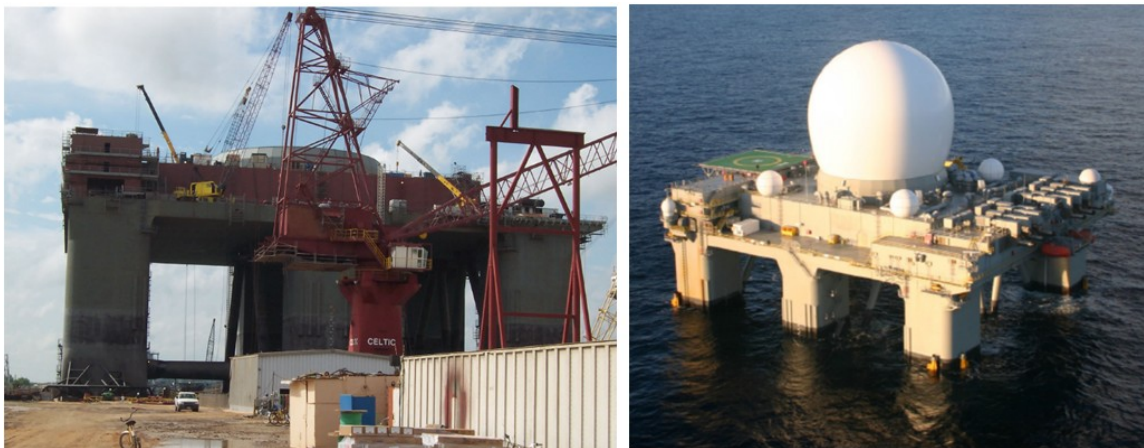
Figura 12: Conversão de plataforma semissubmersível em Base Radar, SBX USNAVY. Fonte: https://missiledefenseadvocacy.org/
